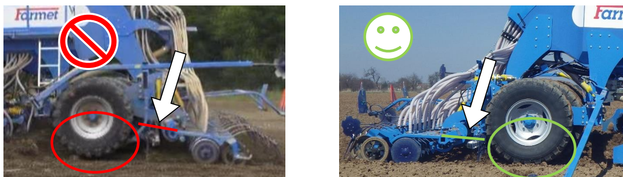
Fig. 58 – situación del manómetro de presión en los dispositivos de siembra
