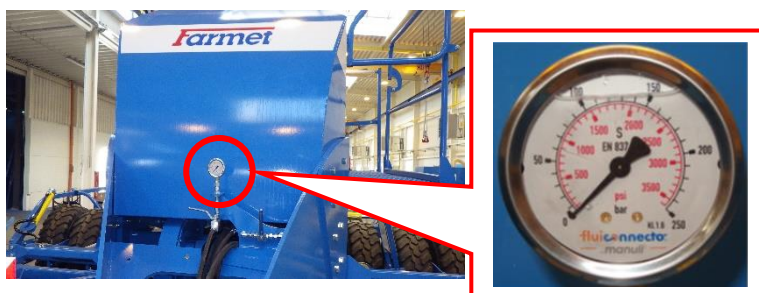
Fig. 58 – situación del manómetro de presión en los dispositivos de siembra
