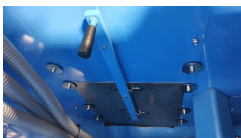
Tabique separador en el depósito de la simiente
