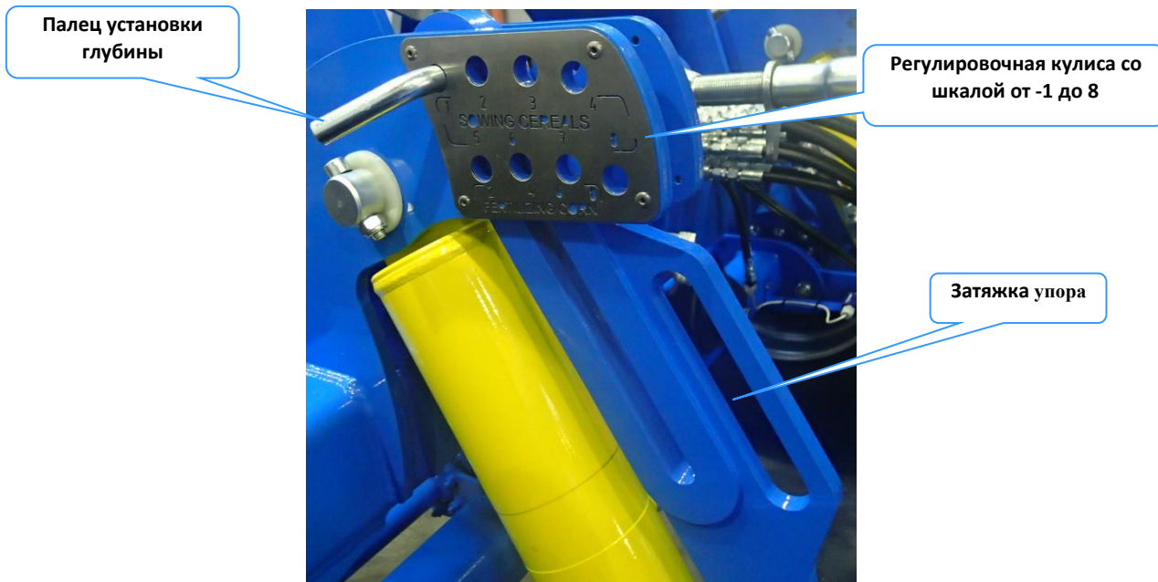
Рис. 42 – Регулировочная кулиса для установки глубины
