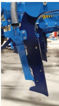
4.1.2 Neue Form des auswechselbaren Meißels
