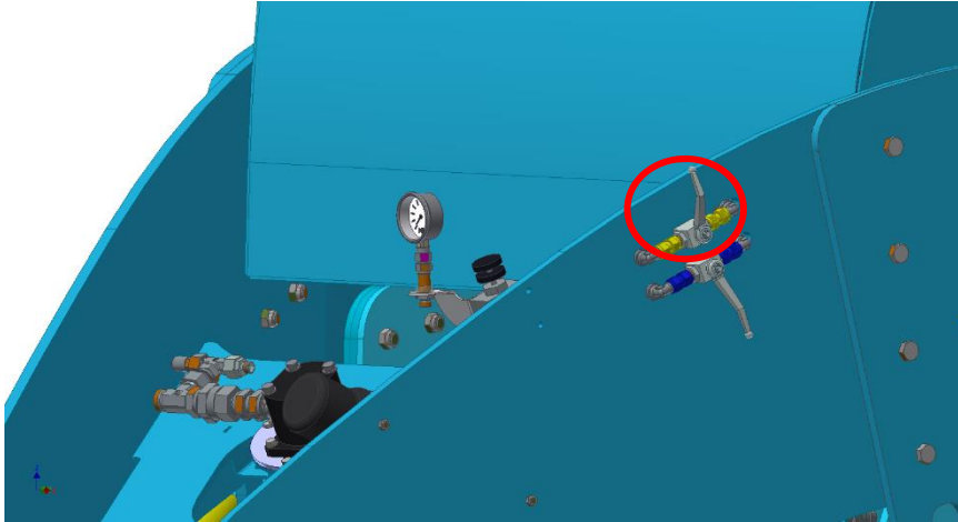
Abb.32 - Kugelventil (gelb) der vorderen Sektion Lage GESCHLOSSEN
