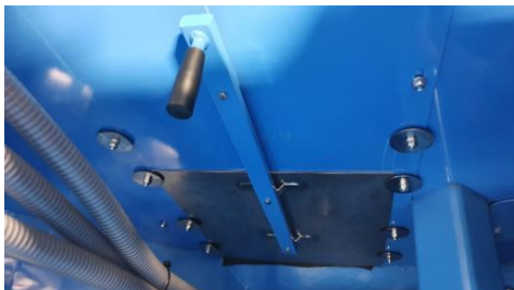
Trennwand im Saatgutbehälter
