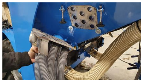
Schnellspannwechselsystem der Zudüngungssektioní
