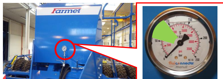
Abb.46 – Platzierung des Druckmanometers für die Aussaatorgane
