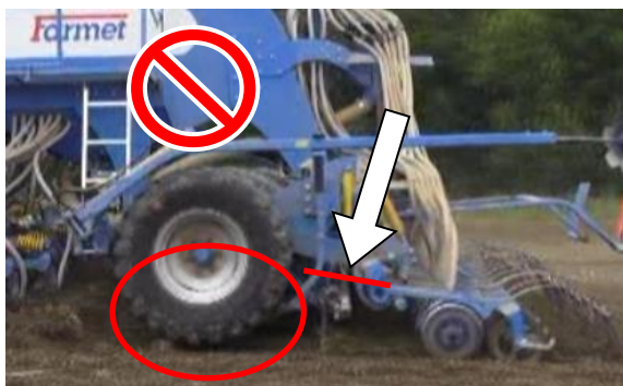
Abb.46 – Platzierung des Druckmanometers für die Aussaatorgane
