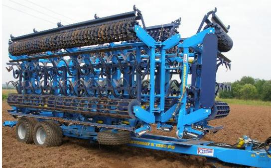
Abb.10-Die Hilfsräder sind zum Aufklappen vorbereitet
