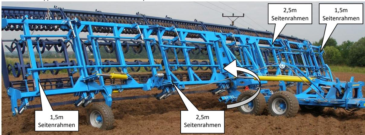
Abb. 13 - Umklappen der Arbeitssektion in die Arbeitsposition
