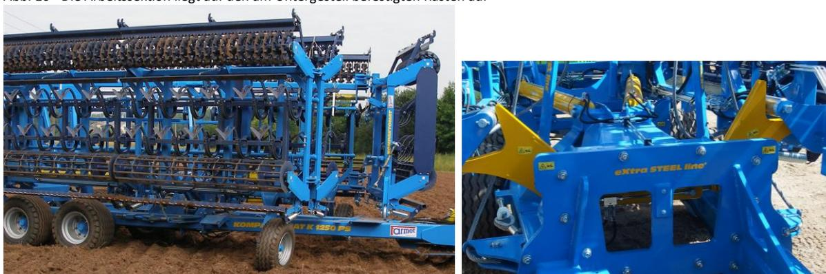
Sichern Sie nach dem Klappen der Maschine in die Transportposition die Seitenrahmen durch die Verbindungsstange und platzieren Sie die Sicherheitsschilder in die Lage für den Transport auf Verkehrsstraßen.
