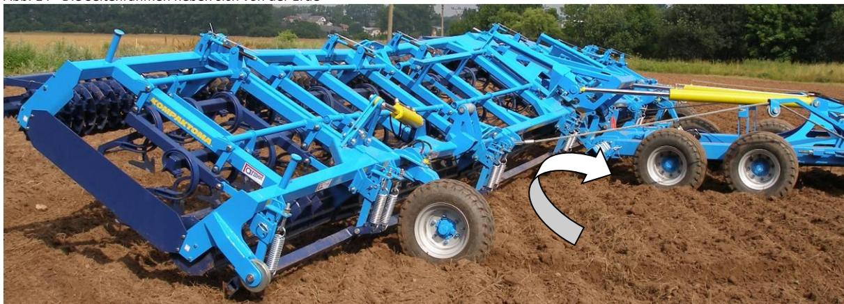
Abb. 15 - Schließen der Arbeitssektionen in die Transportposition
