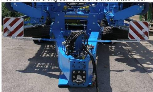
Abb. 18 - Platzierung der hinteren Sicherheitsschilder
