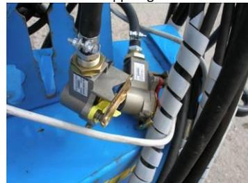
Abb.28-Detail der Beschreibung der Ventilbedienung der Bremsen
