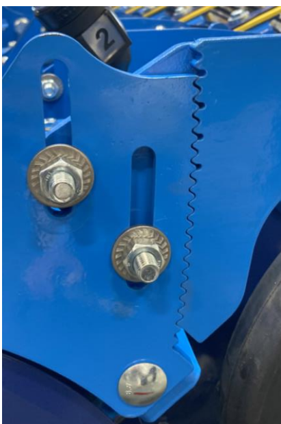
Absenkung der Drillschare um 1 cm.
