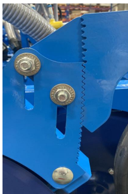
Absenkung der Drillschare um 4 cm.
