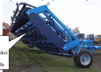
obr.31-poloha pracovní sekce pro výměnu radlic na poli
