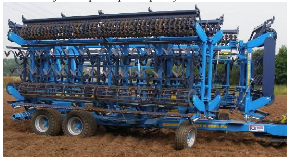
obr.30- stroj v transportní poloze pro výměnu radliček
