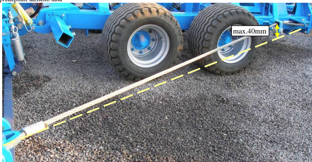
Obr.24-předeptnutí tažného lana
