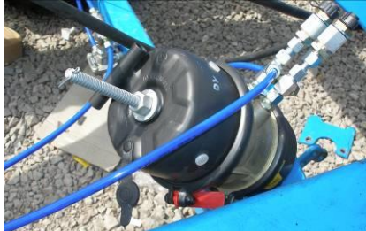
obr.28-detail popisu ovládání ventilu brzd
