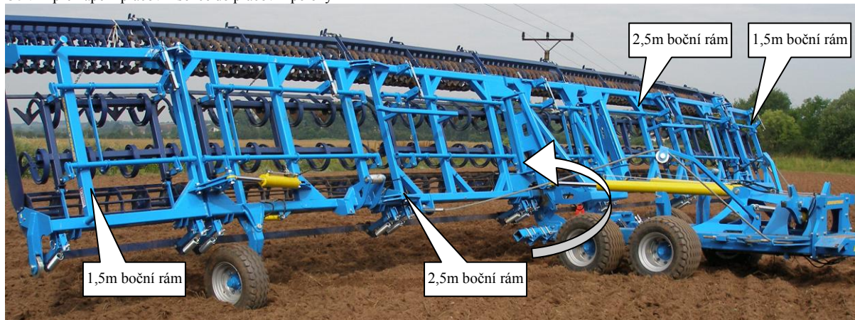
Obr.12-překlápění pracovní sekce do pracovní polohy
