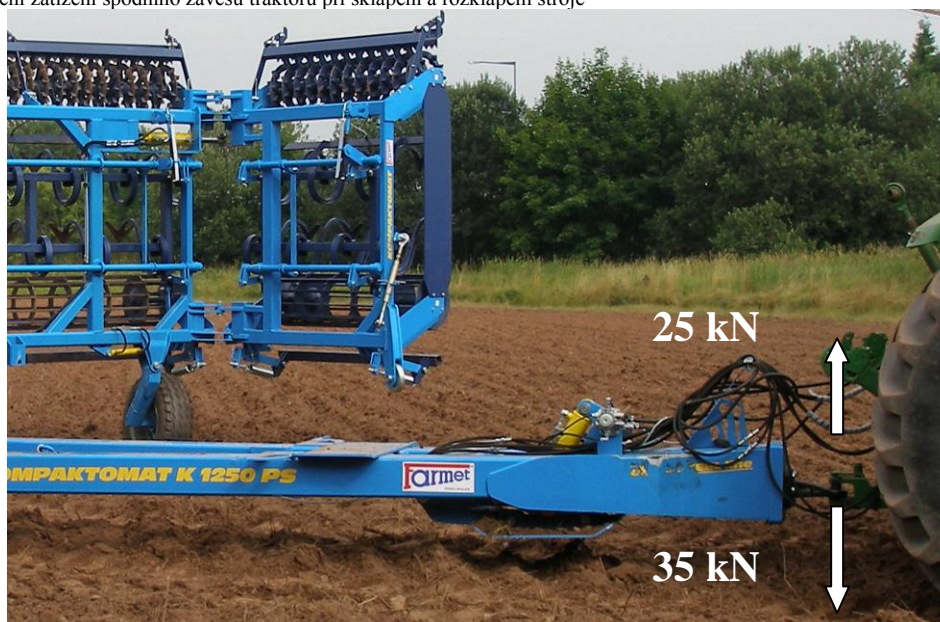
Obr.6-znázornění zatížení spodního závěsu traktoru při sklápění a rozklápění stroje
