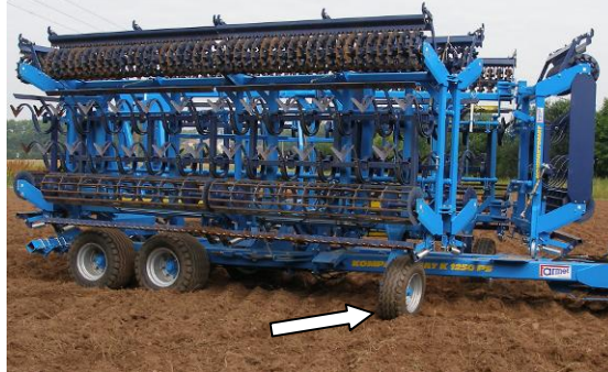
Obr.10-pomocná kola jsou připravena pro rozklápění stroje
