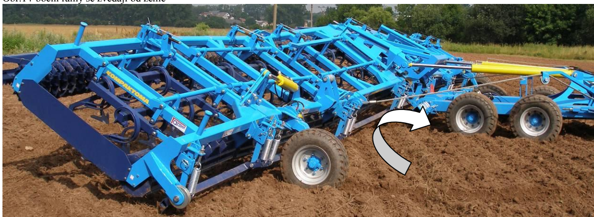
Obr.14-boční rámy se zvedají od země
