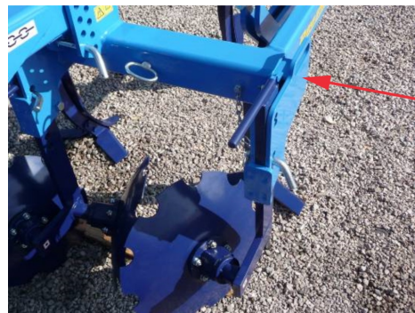
Fig. 5 - rouleau double arrière en position de transport
