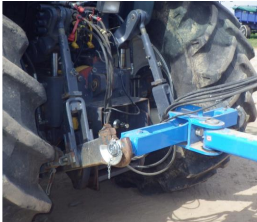
Agrégation dans l'attelage arrière à trois points
