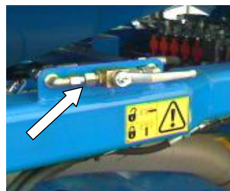
Abb.19 - Kugelventil der Achse und die Seitenrahmen, Position AUF
