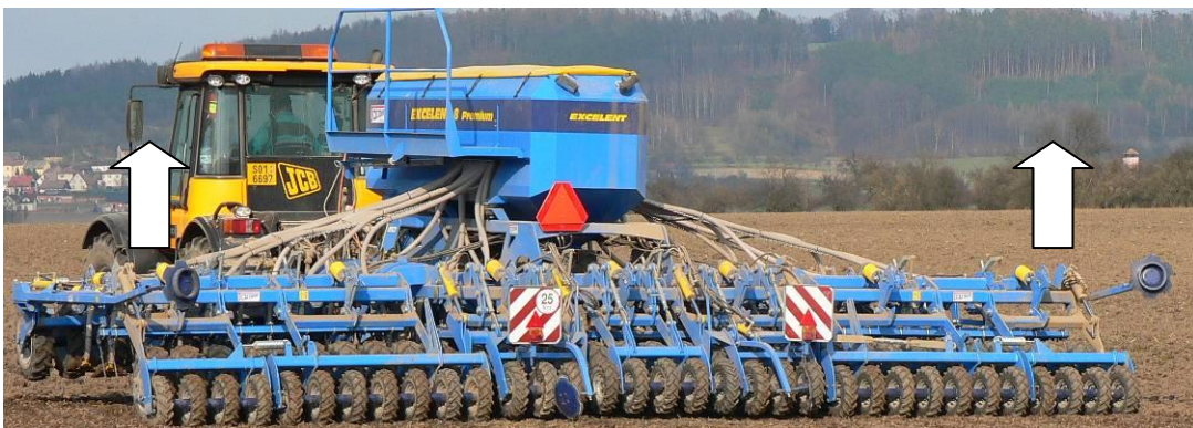
Abb.17 – Anheben der Randsektionen der hinteren Walzen
