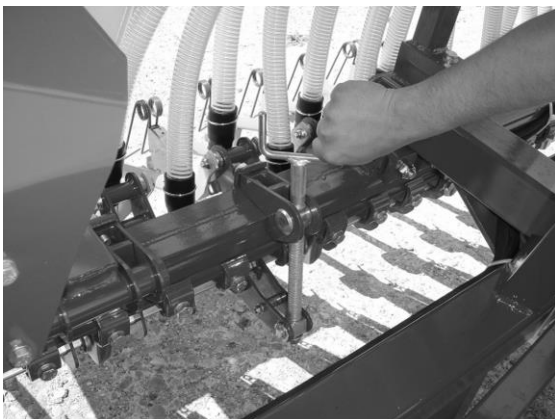
Abb. 3 Zentrale Einstellung des Andrucks auf die Drillschare
