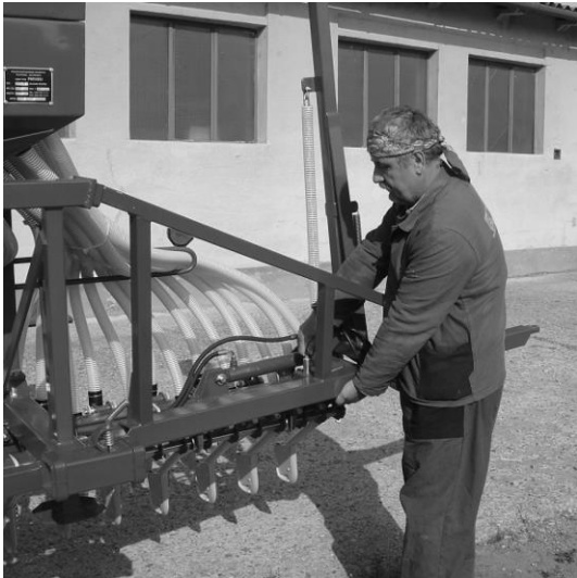
3. die Deichsel entsichern und herausziehen
