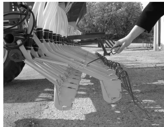
Abb. 4 Individuelle Änderung des Andrucks auf das Drillschar
