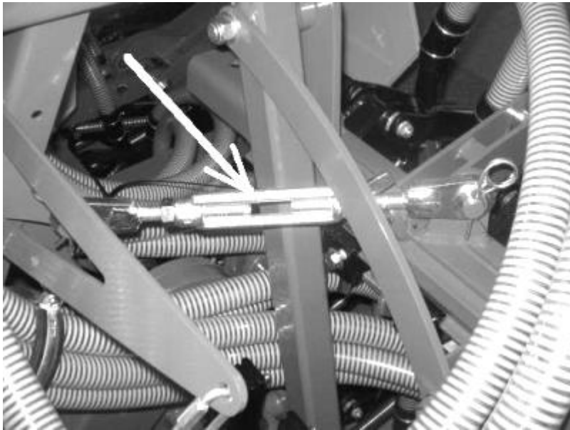
Abb. 12a Absicherung der klappbaren Teile in der Transportlage
