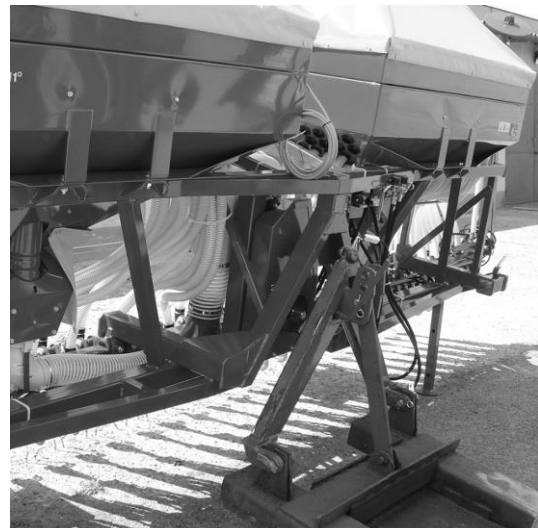
2. die Maschine in die Arbeitslage ankoppeln und anheben
