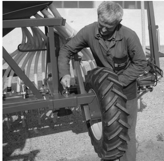
6. das Rad mit dem Antrieb einsetzen
