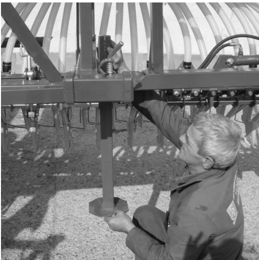
1. die Hilfsstütze ablassen und die Maschine abkoppeln
