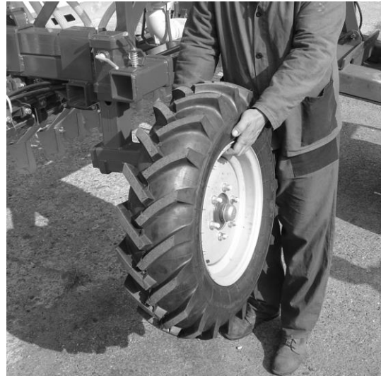
4. das rechte Rad entsichern, herausziehen, um 90° Drehen. Um eine Öffnung höher einschieben und sichern
