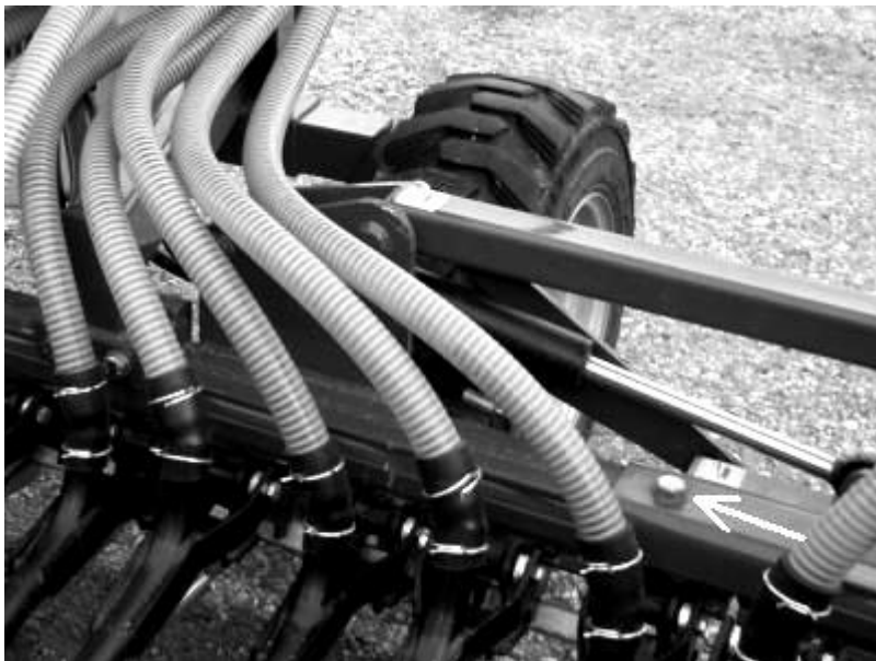
Abb. 12b Absicherung der klappbaren Teile in der Arbeitslage
