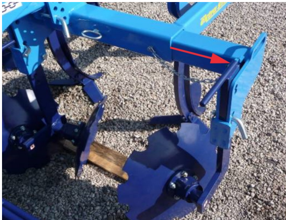
Abb. 5 - Hintere, doppelte Walze in Arbeitslage
