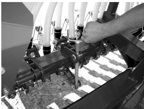
Рис. 3. Центральная установка давления на секции
