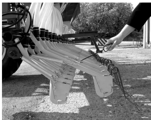
Рис. 4. Индивидуальное изменение давления высевные на высевную секцию
