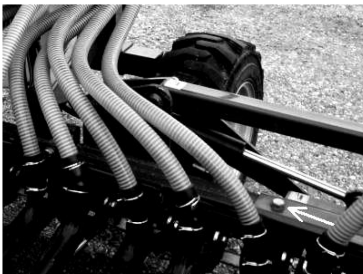
Рис. 12б. Фиксация складывающихся частей в рабочем положении
