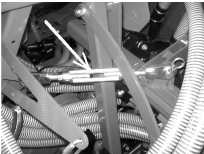
Рис. 12а. Фиксация складывающихся частей в транспортном положении
