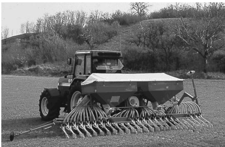
Рис. 13. Сеялка MD с шириной захвата 6 м
