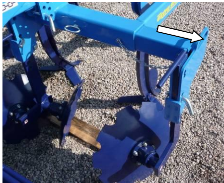
Fig.3a – discos móviles laterales en la posición de trabajo
