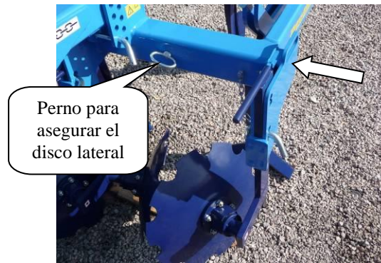
Fig.3b – discos móviles laterales en la posición de transporte
