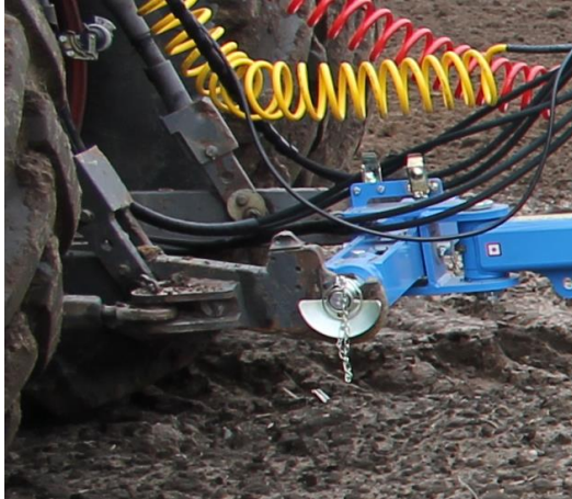
Aggregieren mit der hinteren TBZ-Aufhängung
