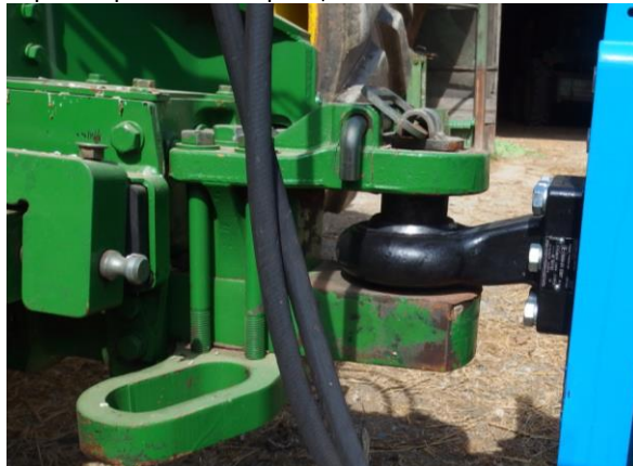
Агрегатирование с агросцепкой
