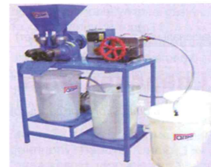
Рис. 3 – Комплект пресувального обладнання Farmer 10/20 фірми «Farmet» (Чехія)
