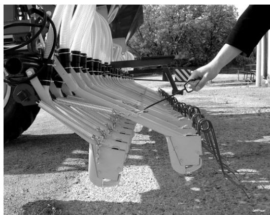
Рис. 4. Индивидуальное изменение давления высевные на высевную секцию
