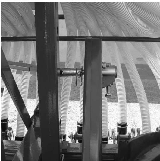
7. Насадить приводной вал и зафиксировать пружинным соединением.
