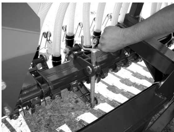
Рис. 3. Центральная установка давления на секции
