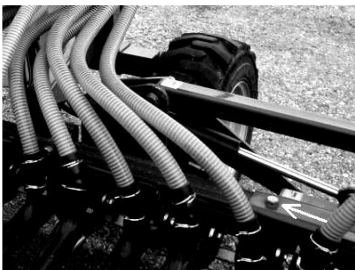
Рис. 12б. Фиксация складывающихся частей в рабочем положении
