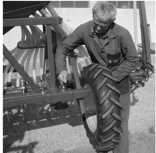
6. Установить колесо с приводом.
