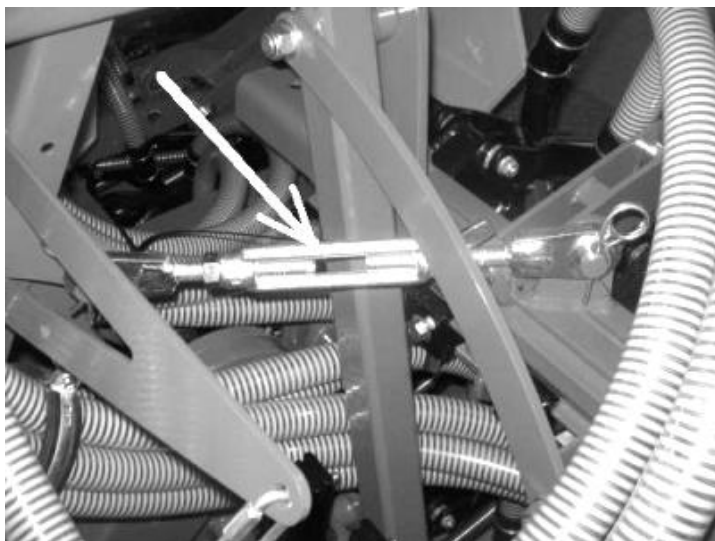
Рис. 12а. Фиксация складывающихся частей в транспортном положении
