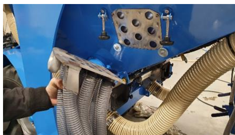
System szybkiej wymiany sekcji nawożenia
