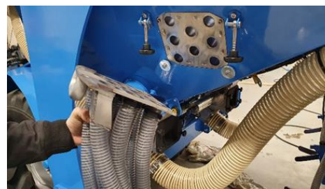
System szybkiej wymiany sekcji nawożenia
