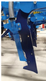
4.1.2 Nowy kształt wymiennego dłuta
