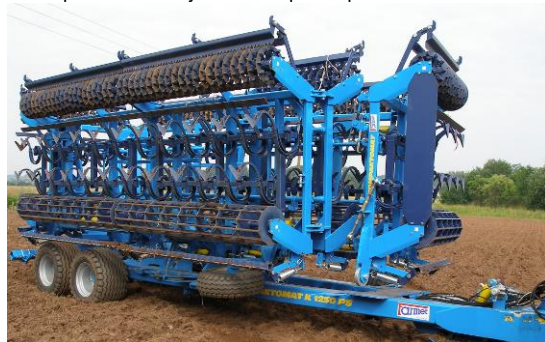
Obr.9-pomocná kola jsou v transportní poloze
