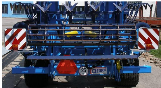
Obr.18-umístění zadních bezpečnostních štítů
