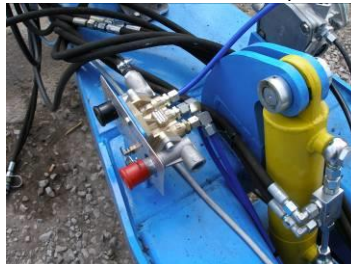
obr.26-ovládací ventil ruční brzdy
