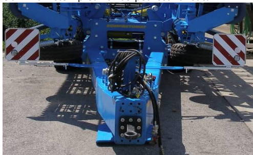
Obr.17-umístění předních bezpečnostních štítů
