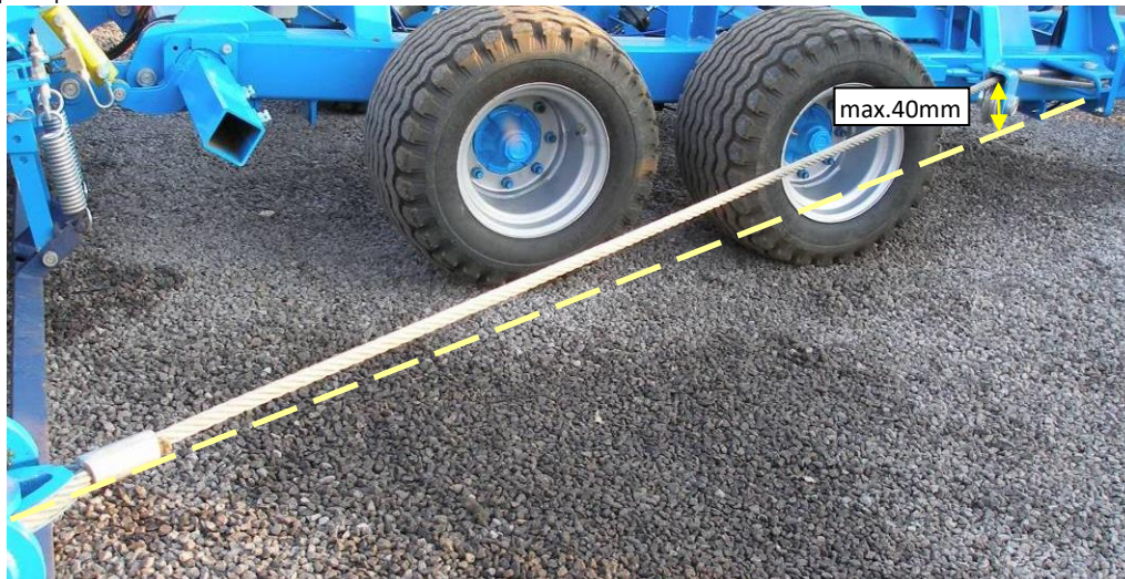
Obr.24-předepnutí tažného lana
