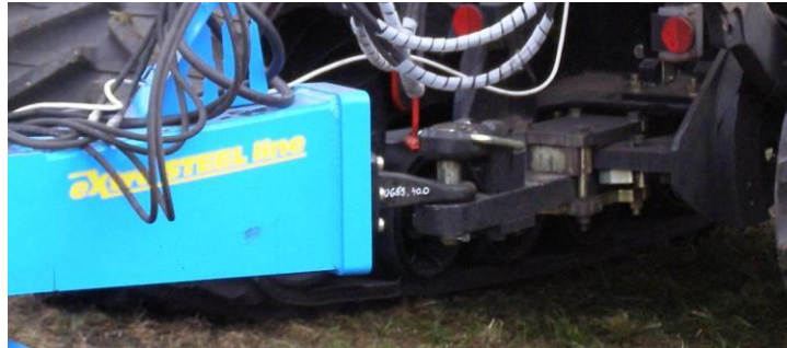
Obr.5-připojení stroje do spodního závěsu traktoru
