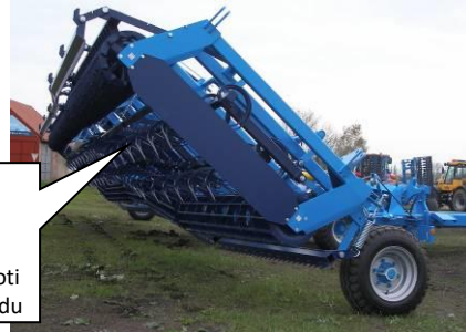
obr.31-poloha pracovní sekce pro výměnu radlic na poli
