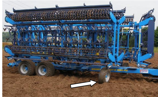
Obr.10-pomocná kola jsou připravena pro rozklápění stroje
