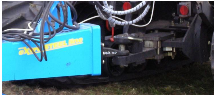
Obr.5-připojení stroje do spodního závěsu traktoru
