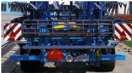
Obr.18-umístění zadních bezpečnostních štítů
