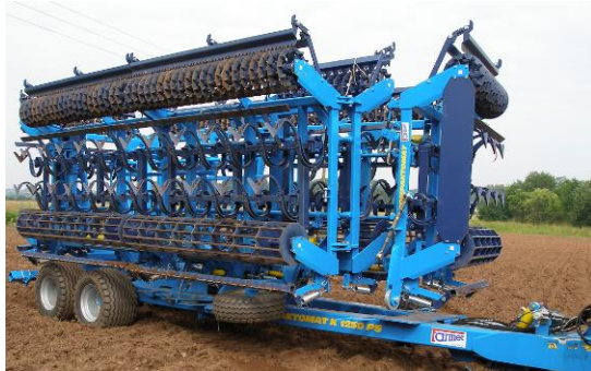
Obr.9-pomocná kola jsou v transportní poloze
