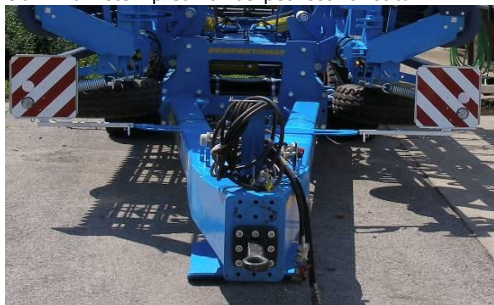
Obr.17-umístění předních bezpečnostních štítů
