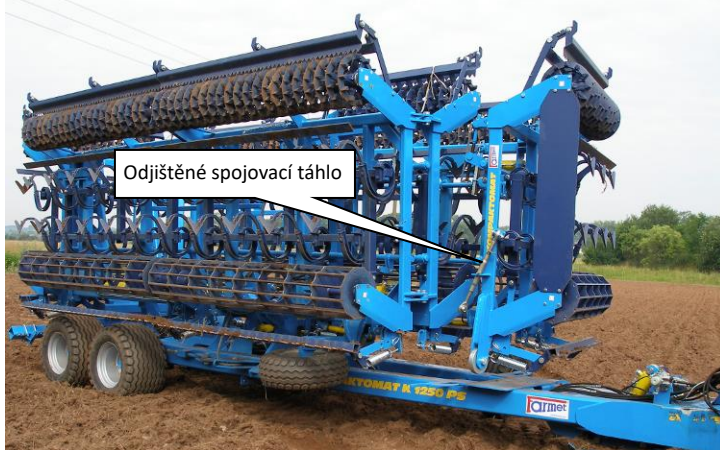
Obr.7-stroj K 1570 PS před zahájením rozklápění
