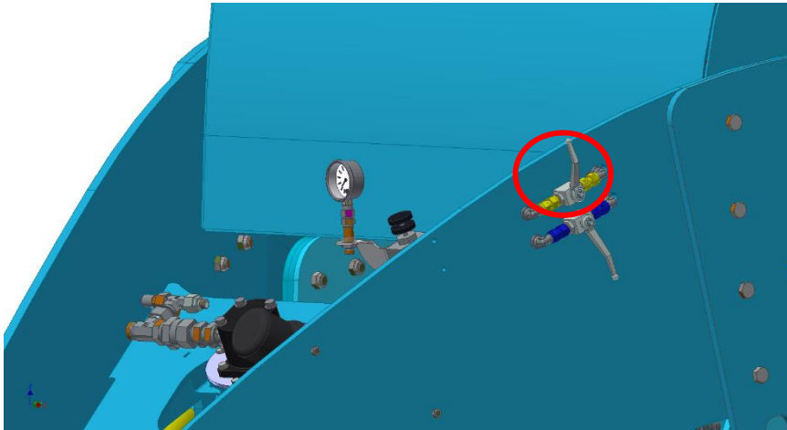
Fig.32 - Vanne de la section avant – position FERMÉE
