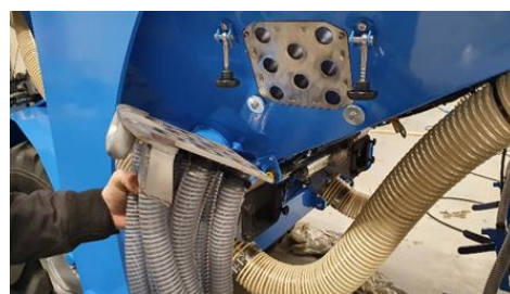
Système de changement à serrage rapide de la section d'amendement
