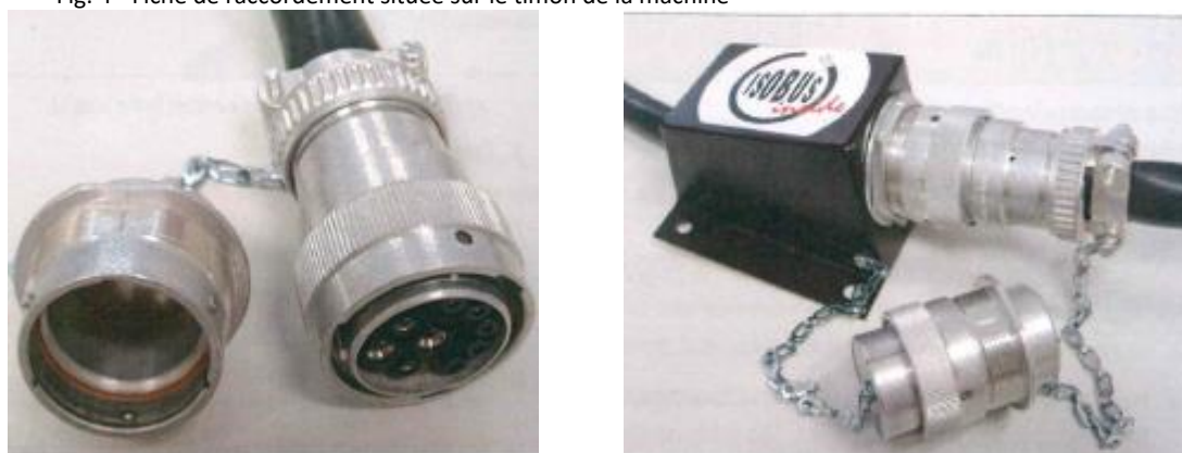
Fig. 4 - Fiche de raccordement située sur le timon de la machine
