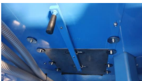
Paroi de séparation dans le réservoir de semences
