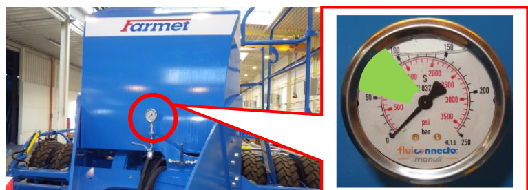
Fig. 46 – Emplacement du manomètre de la pression exercée sur les organes de semis
