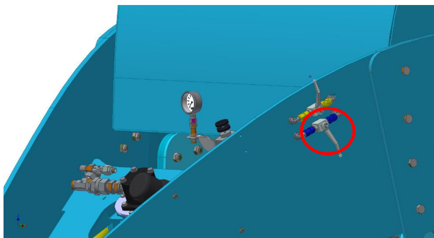
Fig. 30 – Fermeture du robinet de repli
