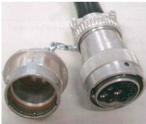
рис. 5 - розетка подключения на дышле машины
