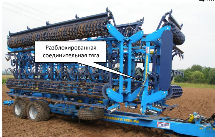
Рис. 7 - машина K 1570 PS перед началом раскладывания
