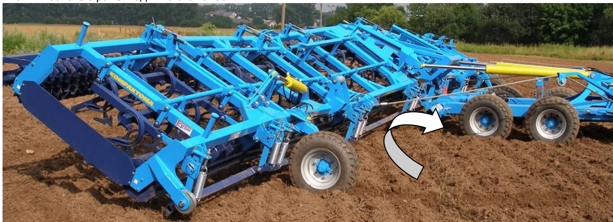
Рис. 15 - закрытие рабочих секций в транспортное положение
