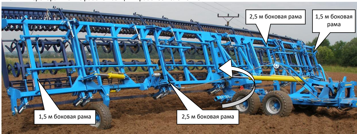
Рис. 12 - переворачивание рабочей секции в рабочее положение
