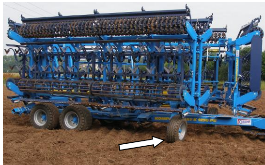
Рис. 10 - вспомогательные колёса подготовлены к раскладыванию машины
