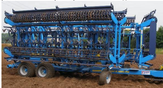
рис. 30 - машина в транспортном положении для замены лап
