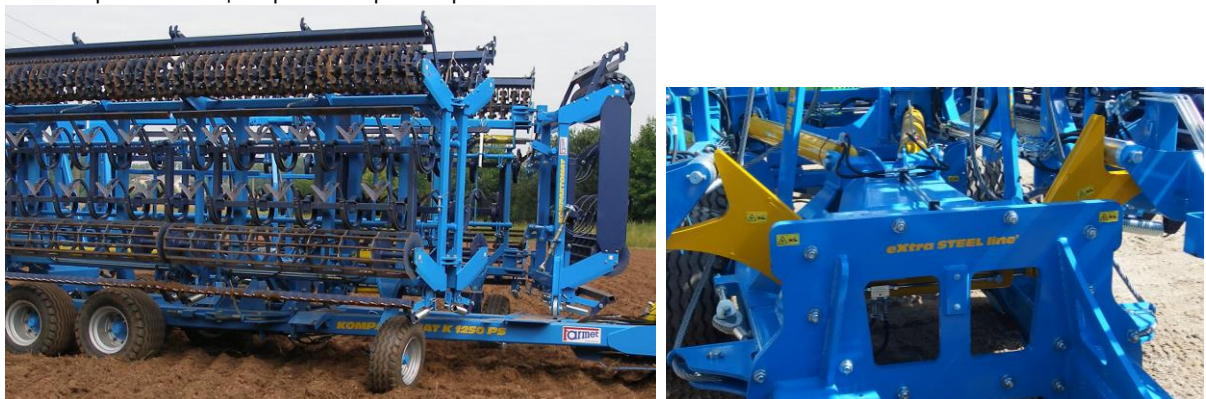
Рис. 16 - рабочая секция прижата к фиксаторам на шасси
