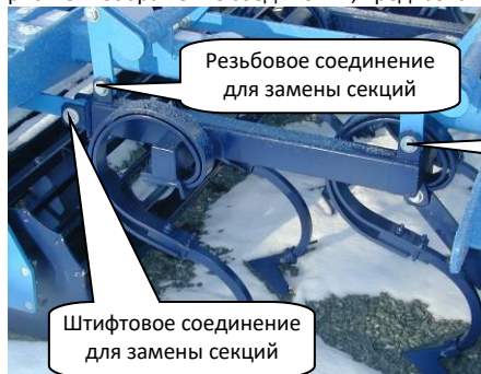
рис. 29- изображение соединений, предназначенных для замены лапчатых секций
