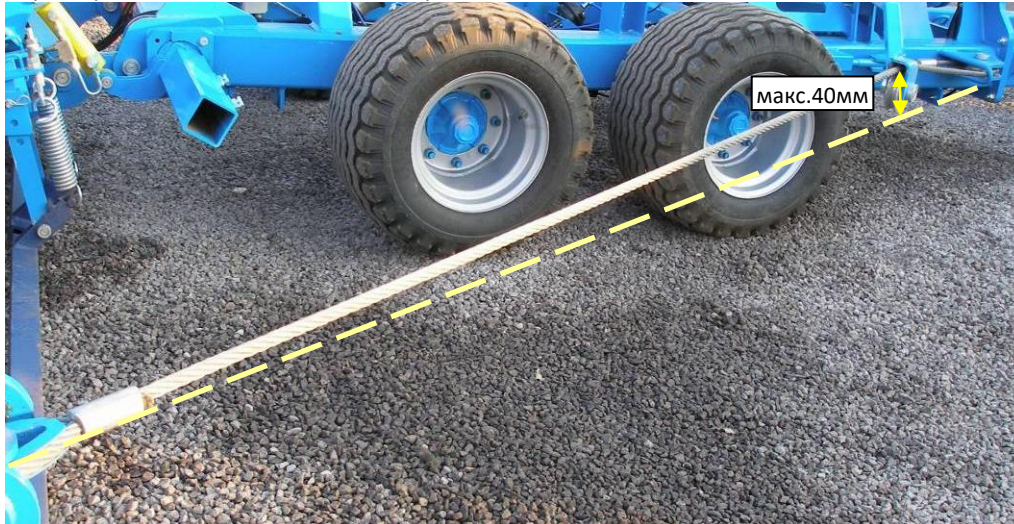
Рис. 24 - предварительное натяжение тягового троса
