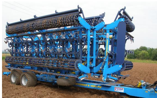
Рис. 9 - вспомогательные колёса в транспортном положении
