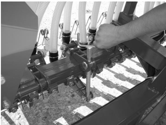
Abb. 3 Zentrale Einstellung des Andrucks auf die Drillschare
