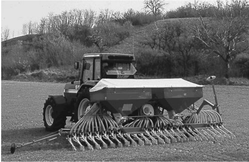
Abb. 13 Sämaschine MD mit einer Arbeitsbreite von 6 m
