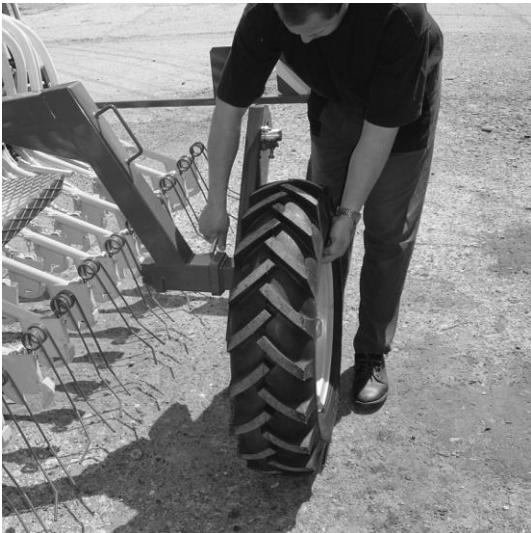
5. das linke Rad mit dem Antrieb entsichern, herausziehen, das Rad auf die Seite der Deichsel verschieben
