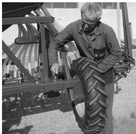
6. das Rad mit dem Antrieb einsetzen
