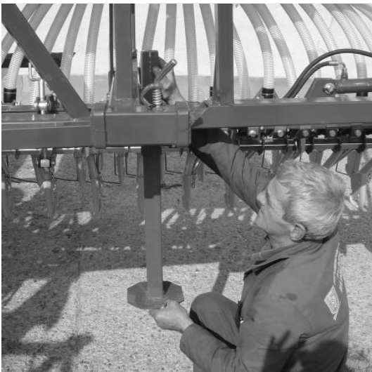
1. die Hilfsstütze ablassen und die Maschine abkoppeln
