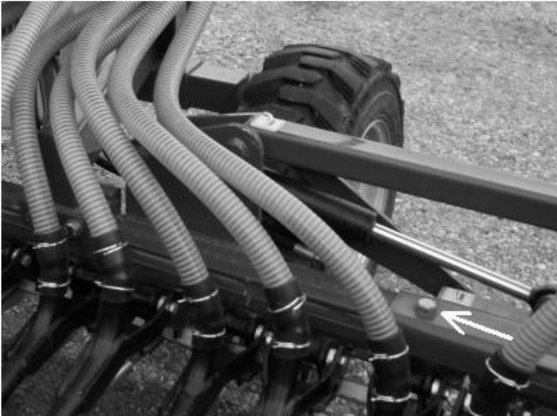
**Fig. 12b** Verrouillage des parties basculantes dans la position de travail
