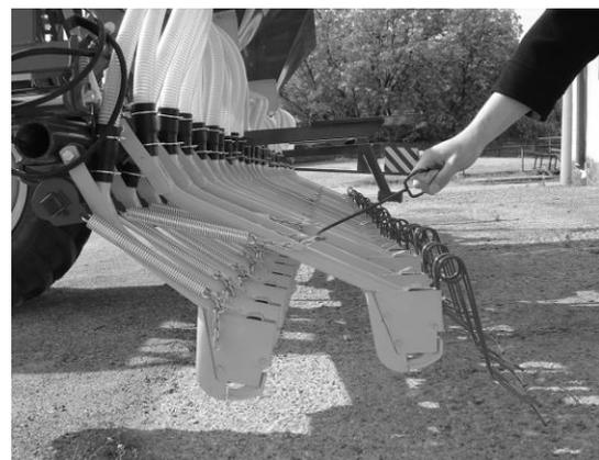
**Fig. 4** modification individuelle de pression sur les éléments semeurs
