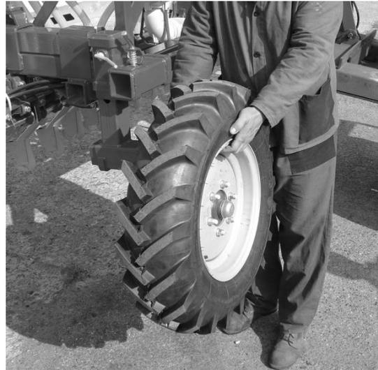
4. Débloquer la roue droite, enlever, tourner à 90°, insérer dans l'orifice supérieur et verrouiller.
