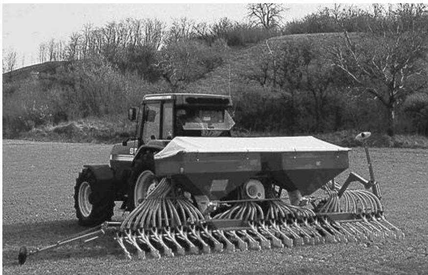
**Fig. 13** semoir MD avec une largeur de travail de 6 m
