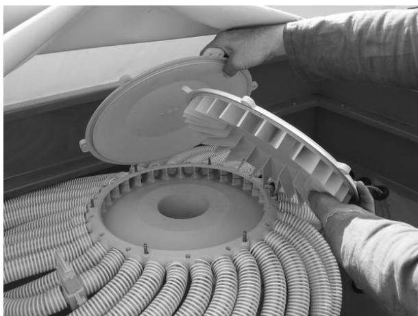
**Fig. 30** montage de la tête de réduction
