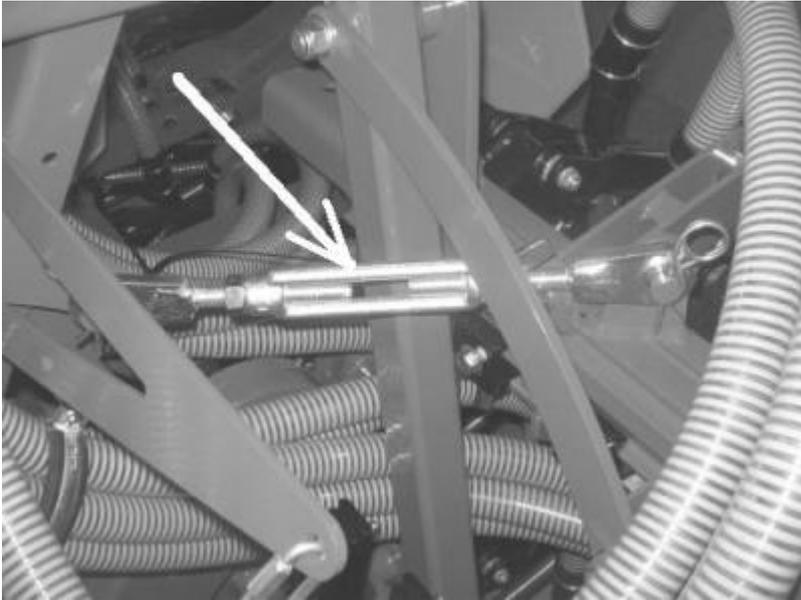
**Fig. 12a** Verrouillage des parties basculantes dans la position de transport
