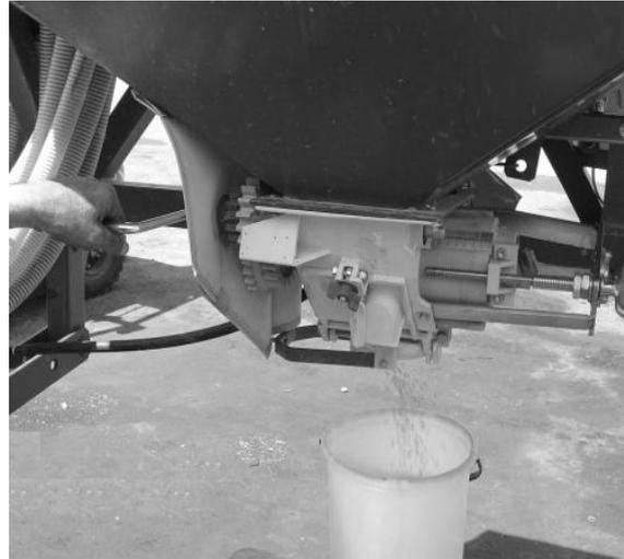
**Fig. 7** calibrage du semoir
