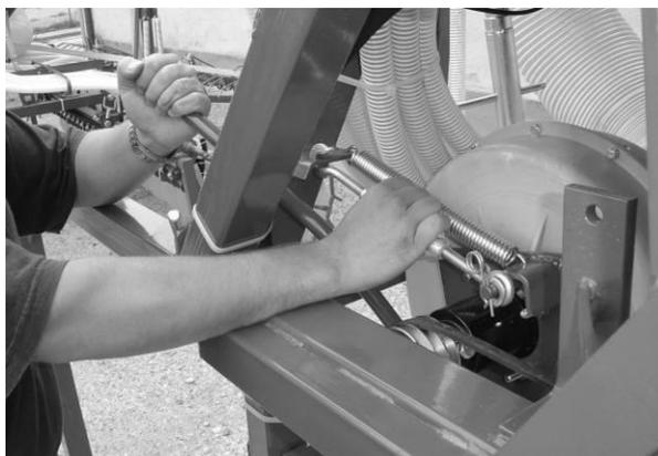
Fig. 22 placement de courroies, MB
