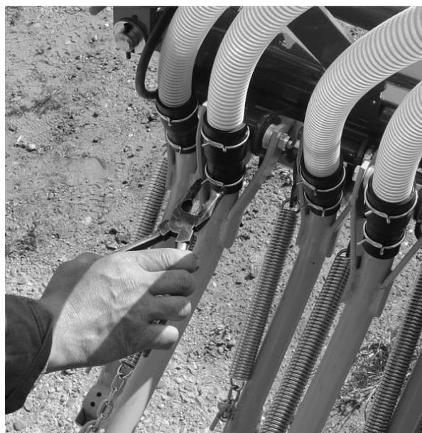
**Fig. 24** montage des tubes de descente
