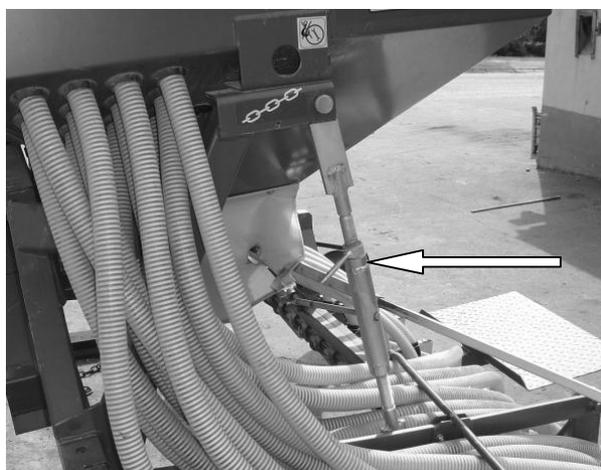
**Fig. 25** vis de tension du parallélogramme
