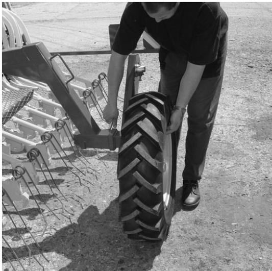
5. Débloquer la roue gauche avec guideau, enlever, déplacer la roue sur le côté du timon.
