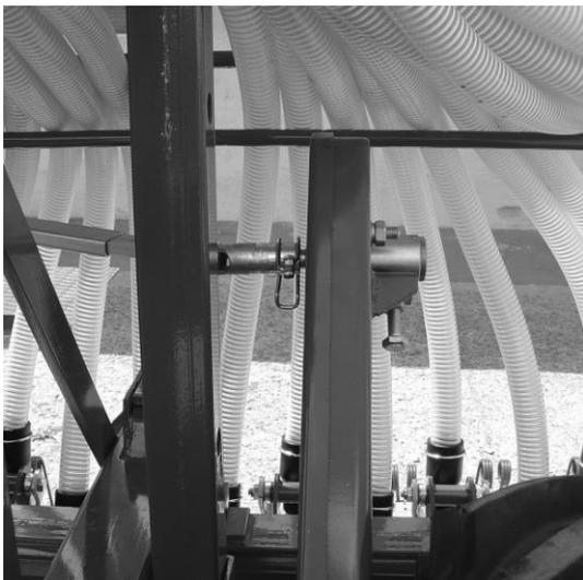
7. Emmancher l'arbre d'entraînement et fixer avec un raccord à ressort.
