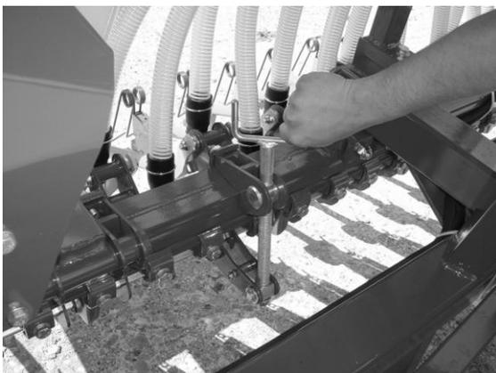
**Fig. 3** réglage central de pression sur les éléments semeurs
