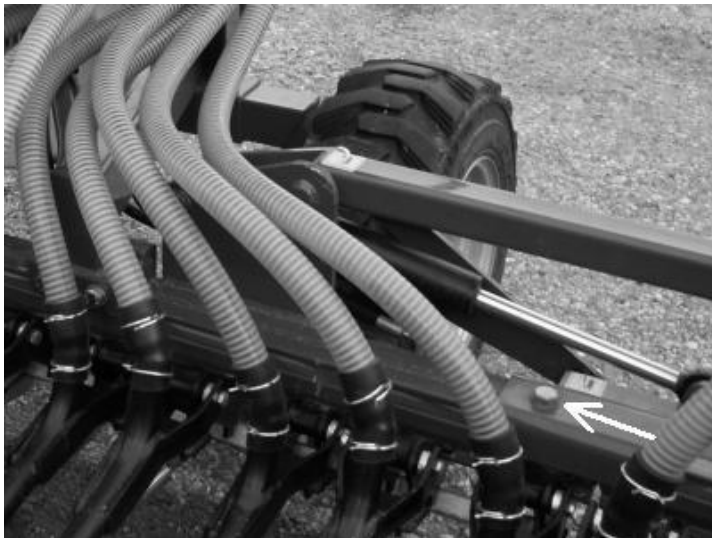
Rys. 12b Zabezpieczenie części ruchomych w pozycji roboczej
