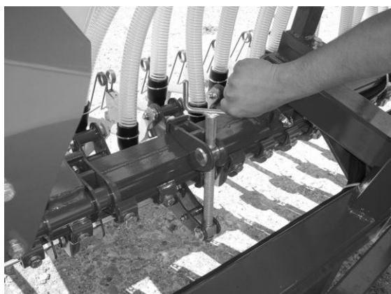
Rys. 3 centralne nastawienie nacisku na sekcje wysiewne
