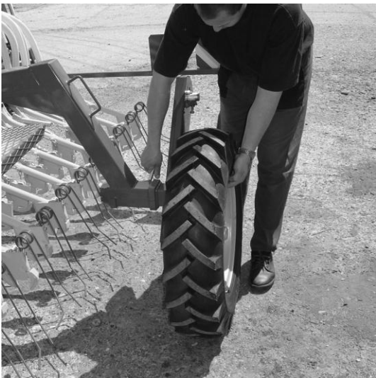
1. Odbezpieczyć lewe koło z napędem, wybrać, przesunąć koło na stronę dyszla.
