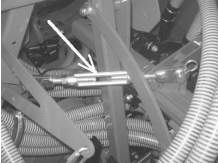
Rys. 12a Zabezpieczenie części ruchomych w pozycji transportowej
