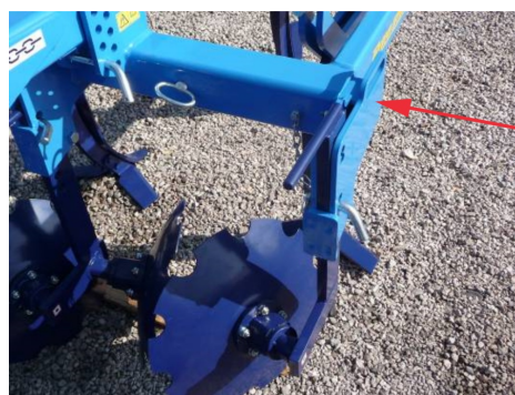
Rys. 6 - tylny podwójny walec w pozycji transportowej
