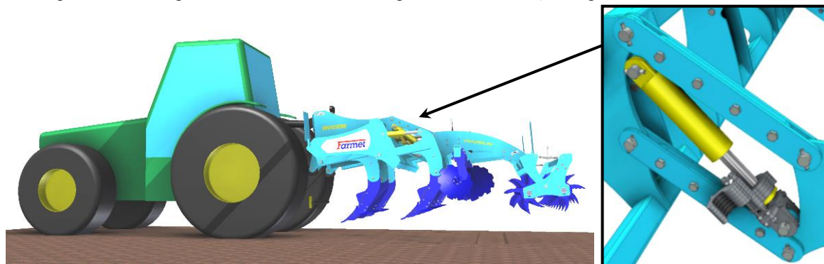
рис. 16 – размещение ограничительных шайб на поршневом штоке цилиндра
