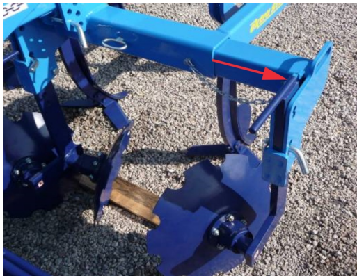
Рис.4 - задний двойной каток в рабочем положении
