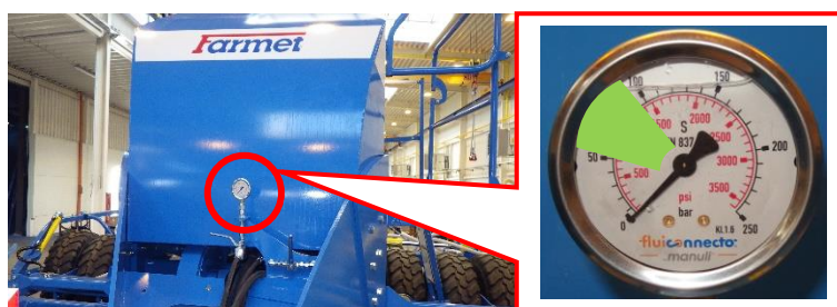
Рис. 58 – размещение манометра давления на рабочих органах сеялки
