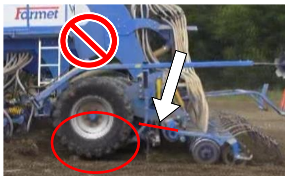
Рис. 58 – размещение манометра давления на рабочих органах сеялки
