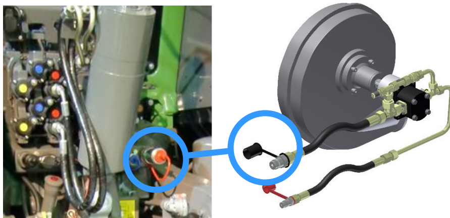
Рис 7 – подсоединение сливного шланга
