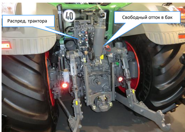
Рис. 6 – размещение штуцеров на тракторе
