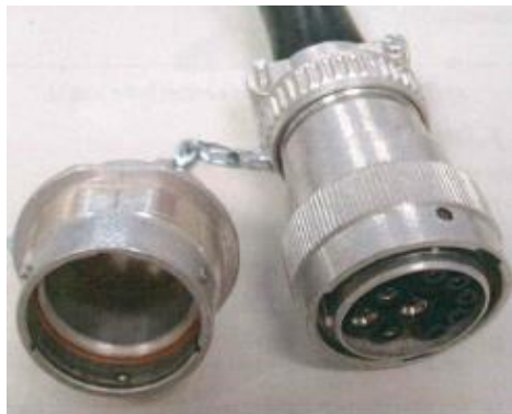
рис. 4 - розетка подключения на дышле машины
