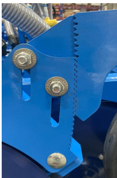
Zagłębienie redlic wysiewających o 4 cm.
