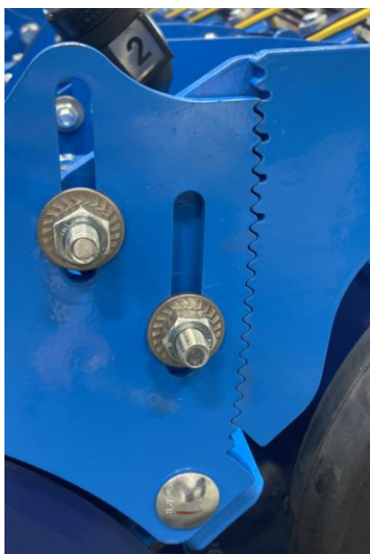
Zagłębienie redlic wysiewających o 1 cm.
