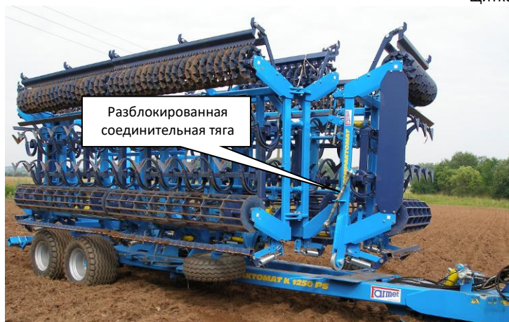
Рис. 7 - машина К 1570 PS перед началом раскладывания
