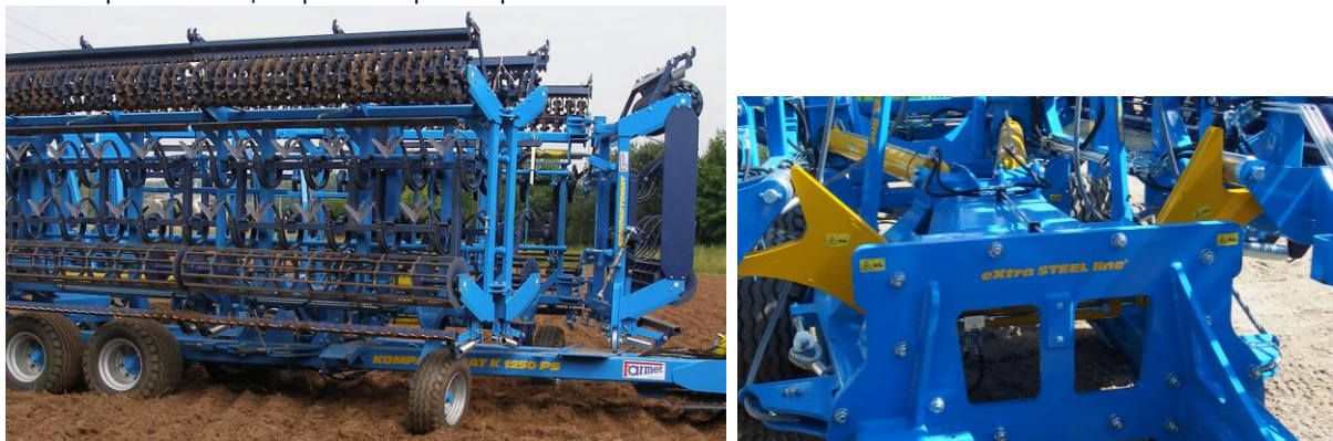
Рис. 16 - рабочая секция прижата к фиксаторам на шасси
