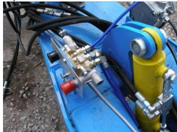
рис. 26 - вентиль управления ручного тормоза
