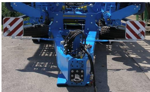
Рис. 17 - размещение передних предохранительных щитков
