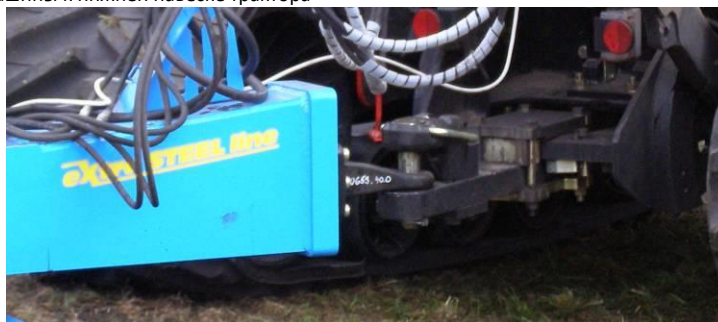
рис. 5 - подсоединение машины к нижней навеске трактора
