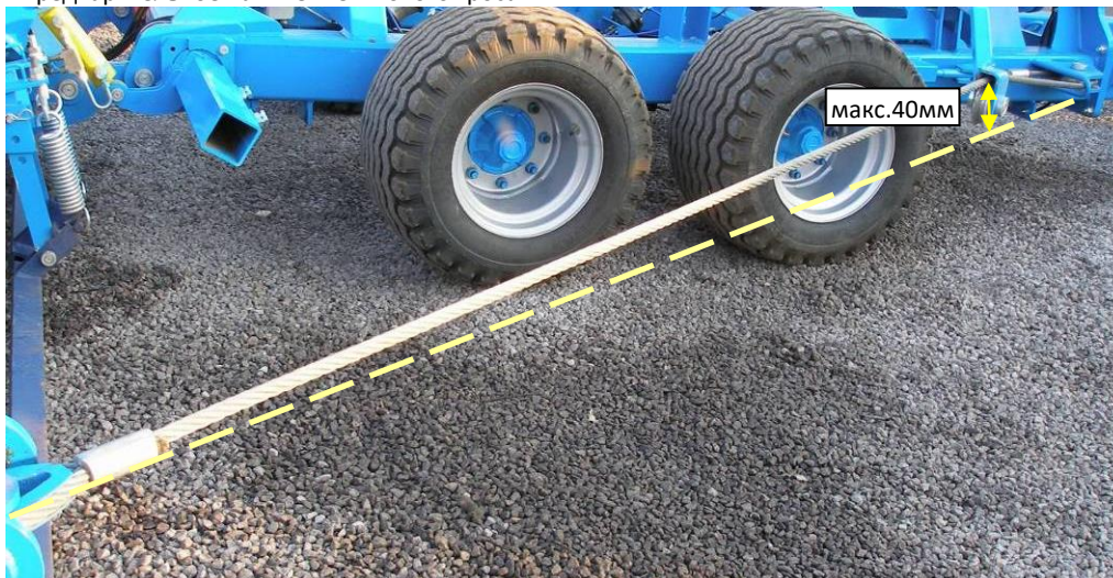
Рис. 24 - предварительное натяжение тягового троса
