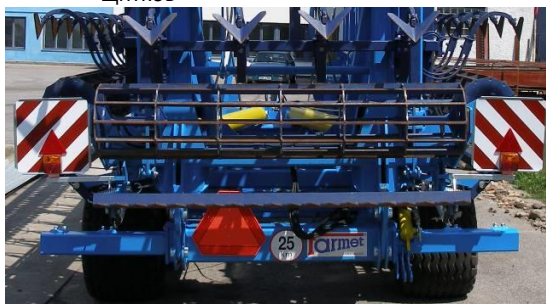
Рис. 18 - размещение задних предохранительных щитков
