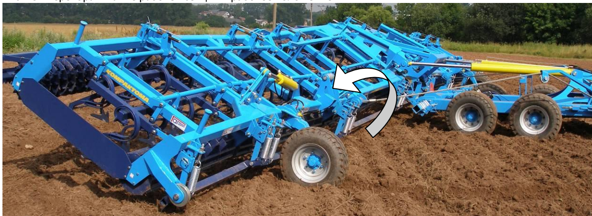
Рис. 13 - переворачивание рабочей секции в рабочее положение
