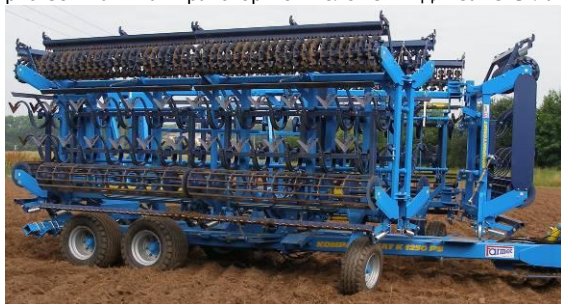
рис. 30 - машина в транспортном положении для замены лап
