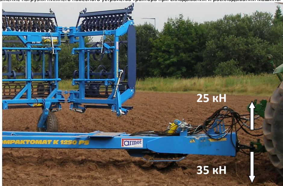
рис. 6 - отображение нагрузки нижнего навесного устройства трактора при складывании и раскладывании машины
