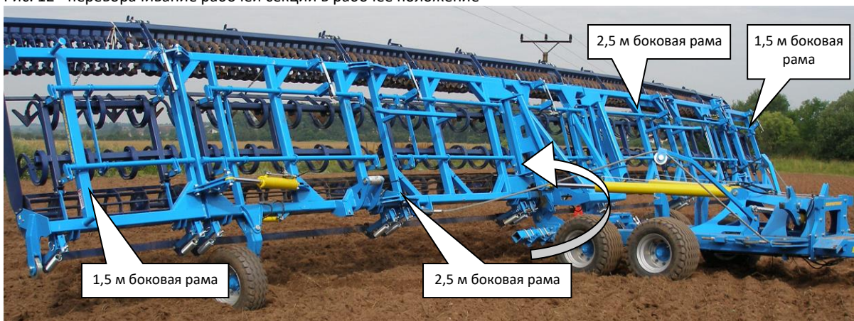
Рис. 13 - переворачивание рабочей секции в рабочее положение
