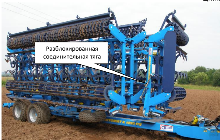
Рис. 7 - машина К 1570 PS перед началом раскладывания
