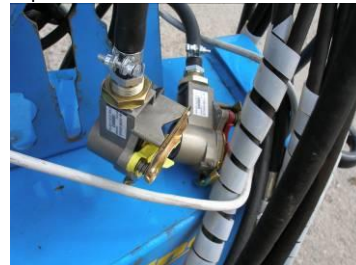
рис. 27 - быстроразъёмные муфты тормоза
