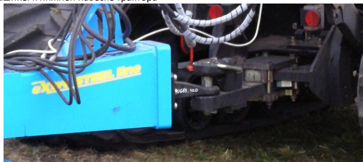
рис. 5 - подсоединение машины к нижней навеске трактора
