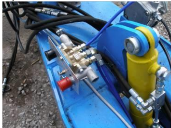
рис. 26 - вентиль управления ручного тормоза
