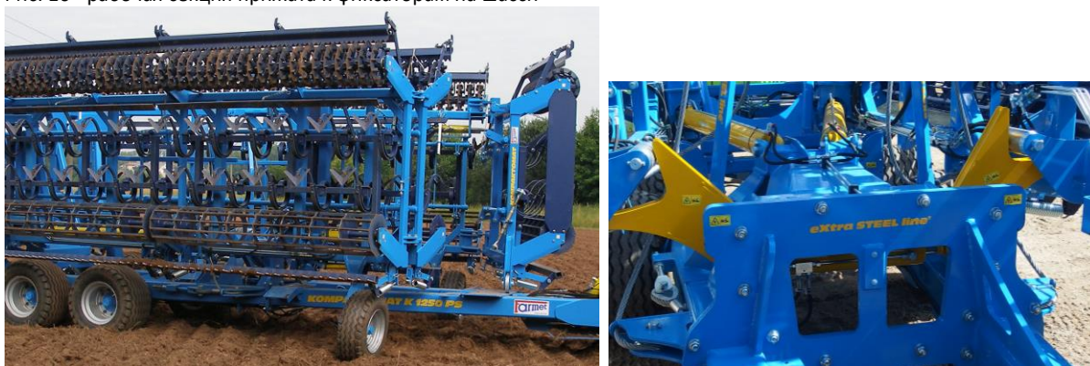
Рис. 16 - рабочая секция прижата к фиксаторам на шасси
