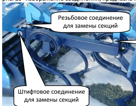
рис. 29- изображение соединений, предназначенных для замены лапчатых секций
