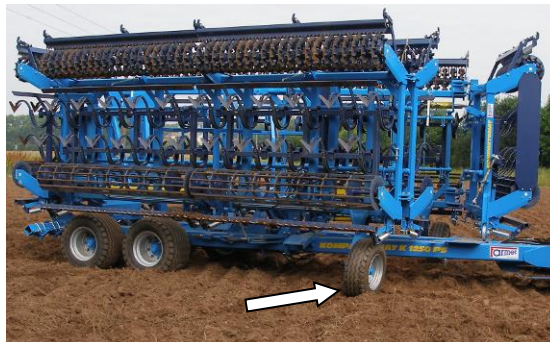
Рис. 10 - вспомогательные колёса подготовлены к раскладыванию машины
