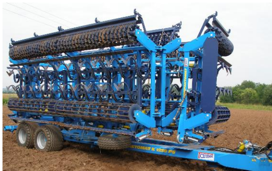
Рис. 9 - вспомогательные колёса в транспортном положении
