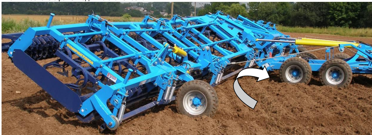
Рис. 15 - закрытие рабочих секций в транспортное положение
