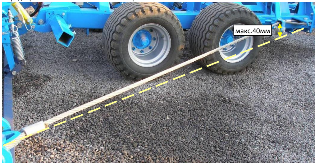
Рис. 24 - предварительное натяжение тягового троса
