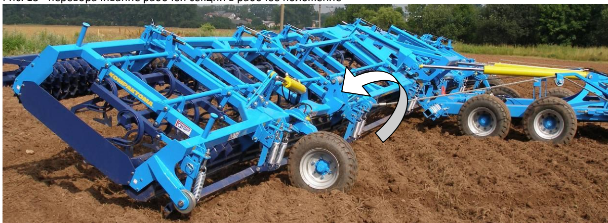
Рис. 13 - переворачивание рабочей секции в рабочее положение
